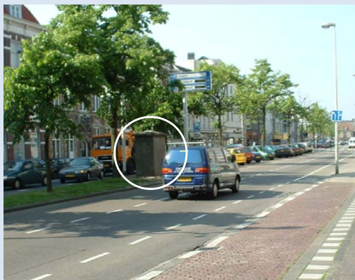
Afbeelding 2. Het meetstation van het Landelijk Meetnet Luchtkwaliteit aan de Amsterdamse Veerkade in Den Haag. Dit is een voorbeeld van een zogenoemd straatstation. Een straatstation geeft meetresultaten waarin de invloed van bronnen dichtbij, meestal het verkeer, duidelijk tot uiting komt. Dit soort stations dient onder andere om de luchtkwaliteit te meten daar waar de mensen zijn.
